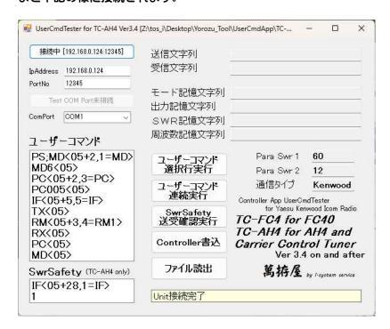
この状態でユーザーコマンド表示部分のテストする行を選択して「選択行実行」ボタンをクリックするとTC-AH4/TC-FC4を経由して無線機にコマンドが送信され、その送信文字列と応答文字列に加えてシーケンス部分により記憶される文字列が表示されます。
