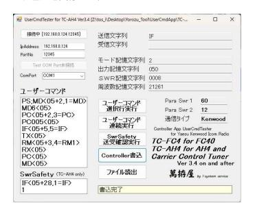
このあと「接続中 [\*\*\*.\*\*\*.\*\*\*.\*\*\*]」ボタンをクリックしますと切断を実行します。 アプリケーションを終了、TC-AH4/TC-FC4の電源をOFF後 JP1 を「UserCmdOp」(;) か (CI-V) を設定して起動しますとTC-AH4/TC-FC4はユーザーコマンド動作で起動します。
