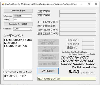
正常に読み込めましたら記述した内容が左下の「ユーザーコマンド」の部分に表示されます。 最後の行のSWRの判定パラメータ1・2と通信のターミネータ(現在のところ八重洲無線さん、ケンウッドさんとも「;」)は画面中央右部分の「ParaSwrl」、「ParaSwr2」、「ターミネート文字」に表示されます。読込が完了することでテストボタン「選択行実行」「連続実行」「SwrSafety送受確認実行」「Controller書込」が有効になります。
