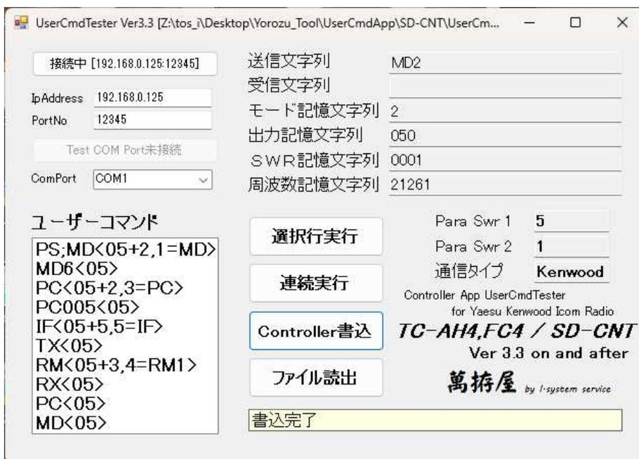
このあと「接続中 [\*\*\*.\*\*\*.\*\*\*.\*\*\*]」ボタンをクリックしますと切断を実行します。アプリケーションを終了、SD-CNTの電源をOFF後JP1を「UserCmdOp」(;)か(CI-V)を設定して起動しますとSD-CNTはユーザーコマンド動作で起動します。
