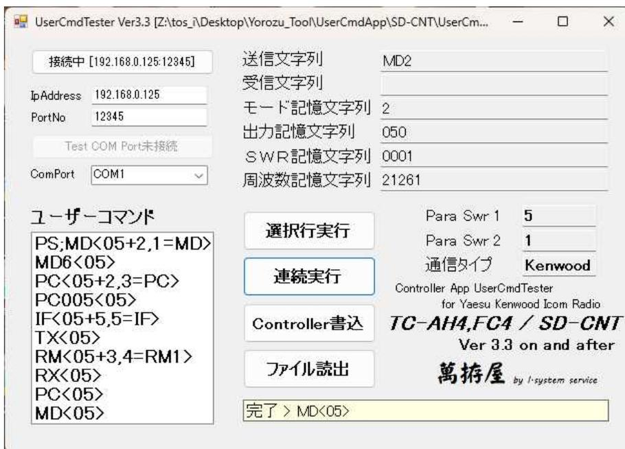
先頭行から順に実行してコマンドを送出・受信して必要な記憶文字列を表示、一連の動作を実行します。この状態がチューニングするにあつて期待通りになるように記述ファイルを修正、読み込み、テストをします。記述ファイルが完成しましたら「Controller書込」ボタンをクリックしますと下記の様にSD-CNTに書込を実行します。
